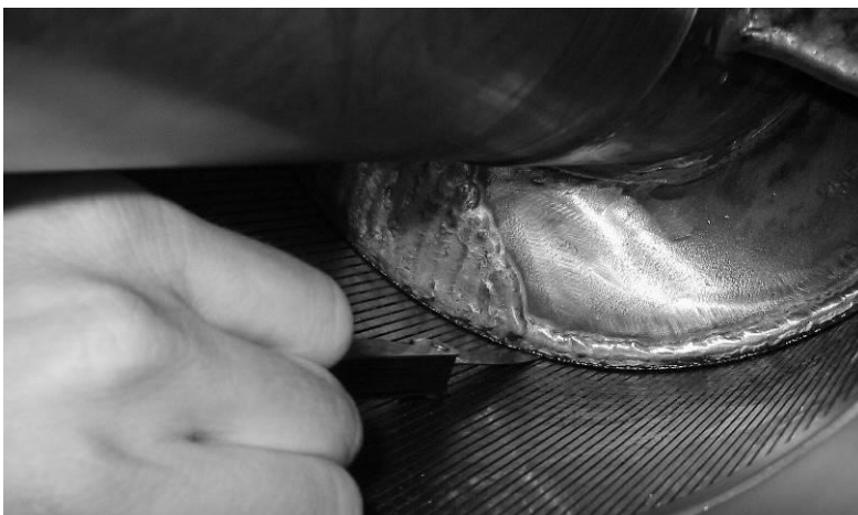
Abb. 13-17: Messung des Arbeitsspalt zwischen Sieb und Schnecke, gemessen wird an der Unterseite des Siebes bei Stillstand der Maschine, die Messung ergibt den 2-fachen Arbeitsspalt, da im ruhenden Zustand das Sieb oben auf der Schnecke aufliegt.
