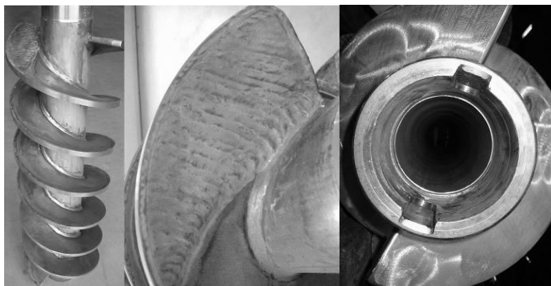
Abb.13-14: Schnecke mit gepanzertem Spezialwerkstoff und Nabenaufnahme, Neuzustand
