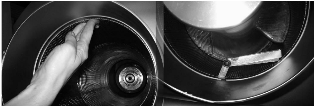
Abb.13-13: Bewegliches Sieb im Separator, Prüfung der Schwimmfähigkeit mit der Hand (links)
