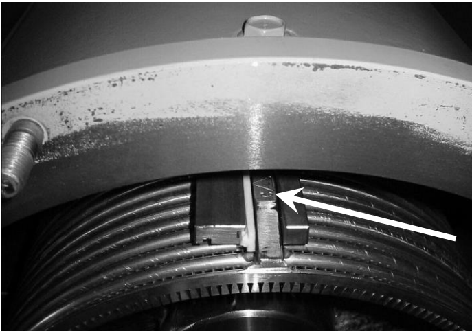
Abb.13-12 Einbauposition des Siebes, eingeschlagenes Dreieck oben und nach vorn zum Separator
